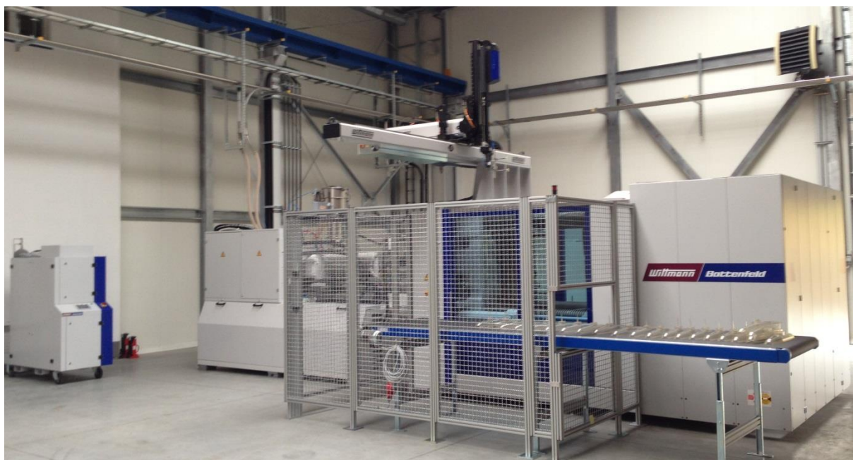
Wtryskarka Battenfeld 800 ton siły zwarcia, rok produkcji 2013
